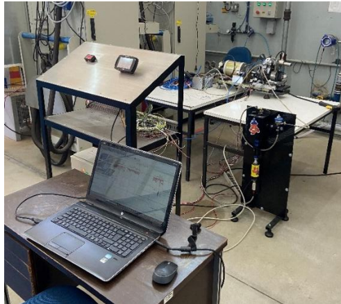
Figura 2 – Configuração completa da bancada didática de testes para o estudo de motores de combustão interna.
