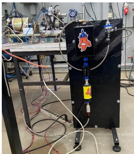
Figura 4 – Sistema de alimentação de combustível da bancada de testes.
